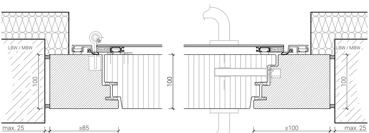
Blockrahmen 100 mm mit Blindstock, Türe stumpf nach aussen öffnend
