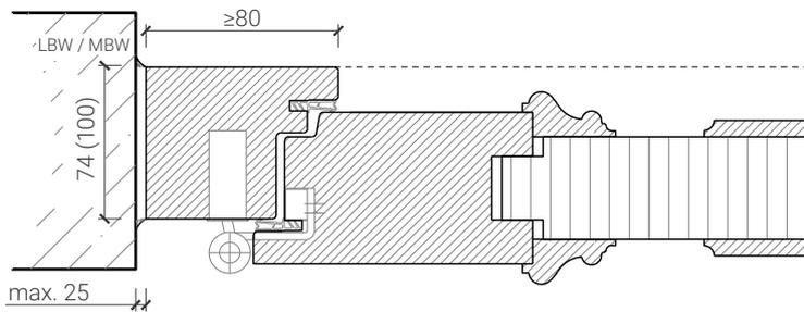
Mittelanschlag 74 / 100 mm, Schlagleisten profiliert
