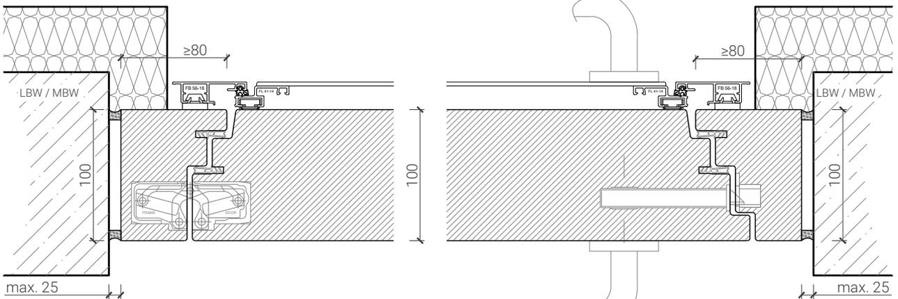
Blockrahmen 100 mm mit Blindstock, Türe stumpf
