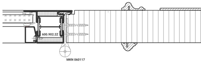
Türblatt stumpf mit Profilaufleistung und Füllungsdoublet profiliert
