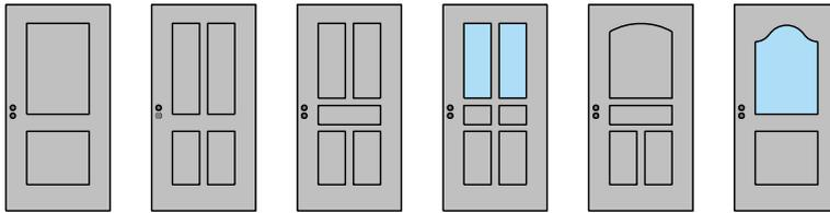
Türblatt stumpf mit Profilaufleistung und Füllungsdoublet glatt
