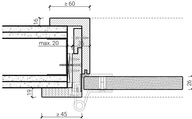
Ganzglastür 26 mm, stumpf einschlagend in Holzblockrahmen
