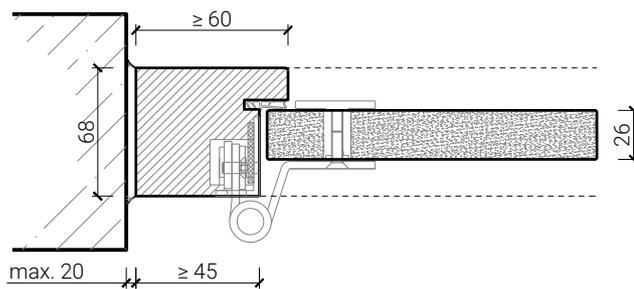
Ganzglastür 26 mm, stumpf einschlagend in Stahlumfassungszarge
