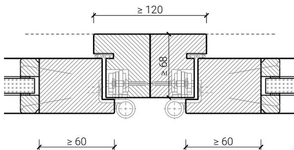
Blockrahmen-Kopplung 68 mm, Türe stumpf
