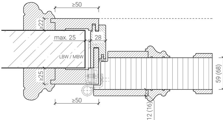
59 / 68 mm Mittelschlag, Schlagleisten profiliert
